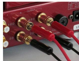
裸線は端子のネジを緩めると軸に穴が空いていますので、そこに線材を差し込み、ネジを締め付けて固定します。
